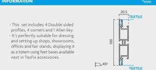
\*The ends are mitred / Couper en biais à 45° / Corte em esquadria de 45° / Cortado a inglete.
